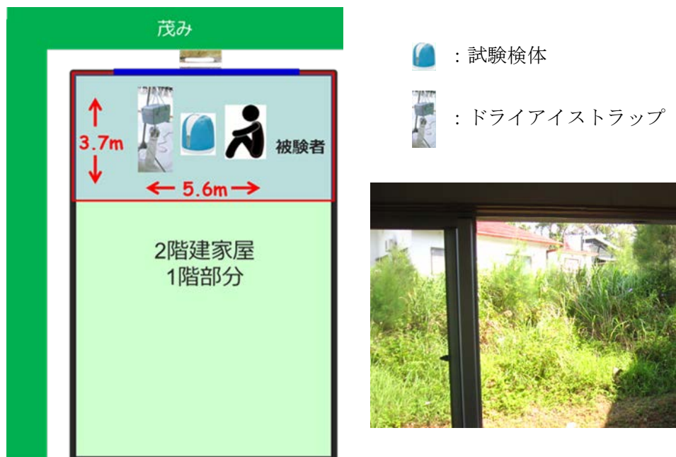
図4 木造家屋A 試験配置図（左）と、試験室から見た茂みの様子（右） 試験室を赤囲み部分（面積：21m 2 、天井高：2.5m）で、試験室の開口部分（高さ2.0m × 幅1.7m）を青太線で示す。開口部分以外は全て密閉した。
