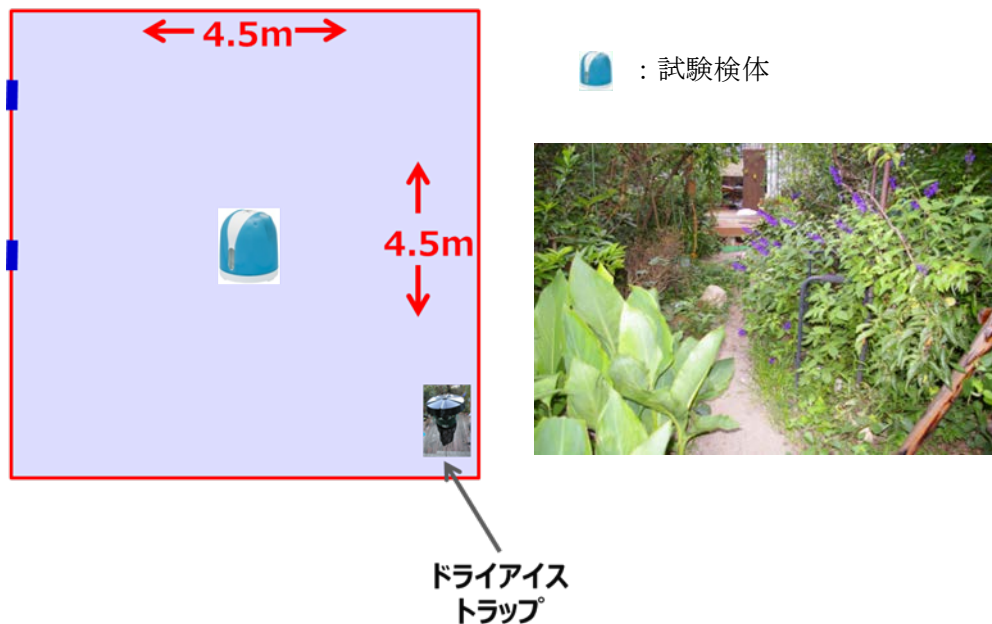
図7 木造家屋C試験配置図（左）と、試験室周辺の茂みの様子（右） 試験室を赤囲み部分（面積：20m 2 、天井高：2.5m）で、試験室の開口部分（高さ1.8m ×幅15cm×2ヶ所）を青太線で示す。開口部分以外は全て密閉した。
