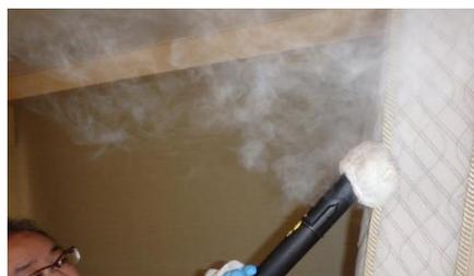
図 6. スチーマーによる加熱殺虫
